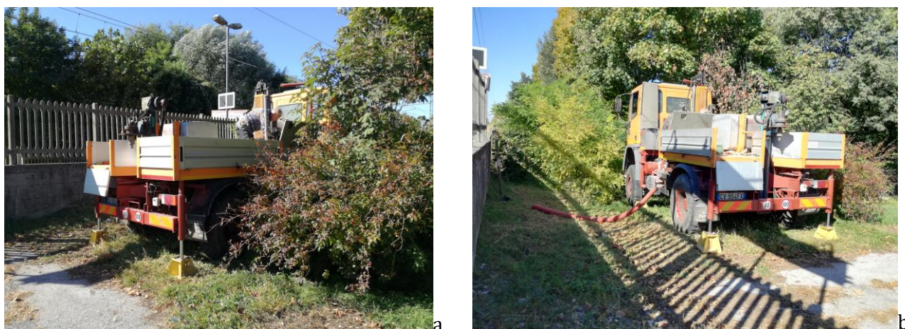
Figura 14 - Esecuzione della prova CPT1
